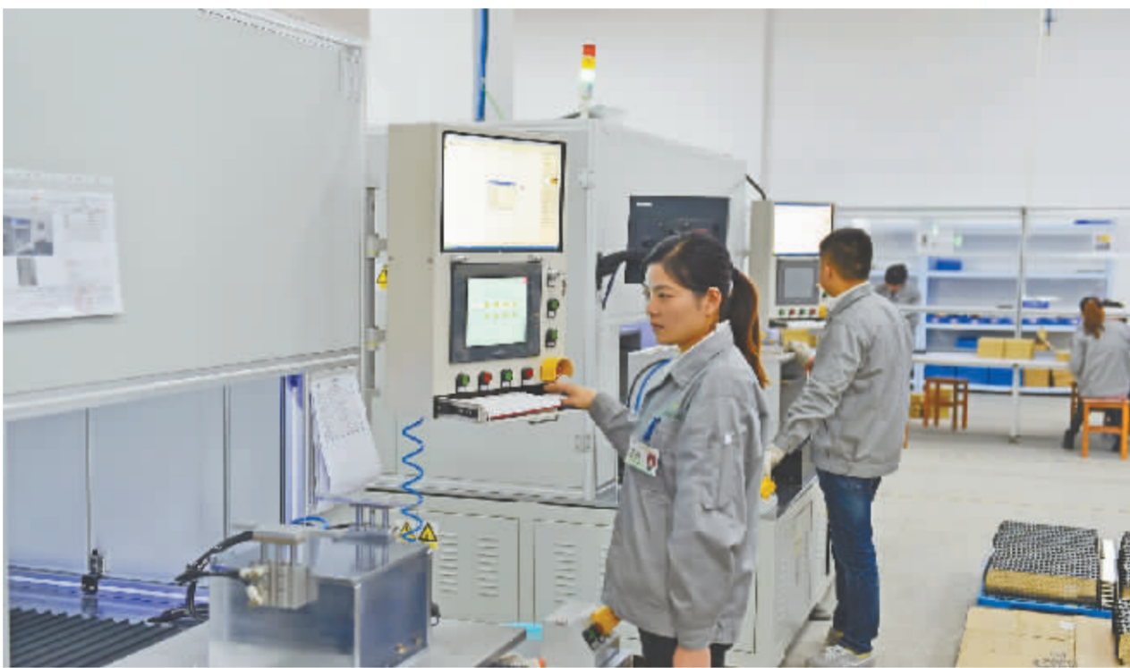
昨天,在盐都区正的新能源汽车电池项目生产车间,工人正在认真操作激光焊接设备。该项目总投资1.5亿元,新上年产100万KW电动汽车锂电池成组生产线,与南京金龙、上海申沃等国内一流车企合作。项目今年8月份正式量产,目前已实现开票销售1亿元,预计到年底将实现产值3亿元、开票销售2亿多元。 本报记者 金胜春 摄
